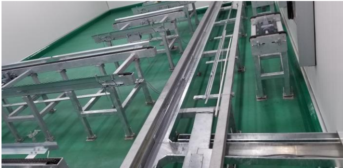
Hệ thống băng tải xích luân chuyển pallet đến các máy chức năng
